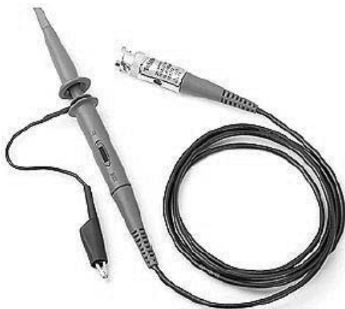
Рис. 5.6. Пассивный пробник P2200 с встроенным фильтром низких частот в положении переключателя деления напряжений 1/10
