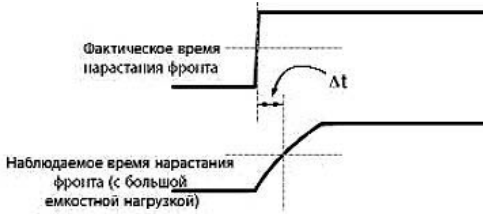
Рис. 4.7. Искажение импульсов вследствие конечной входной емкости канала
