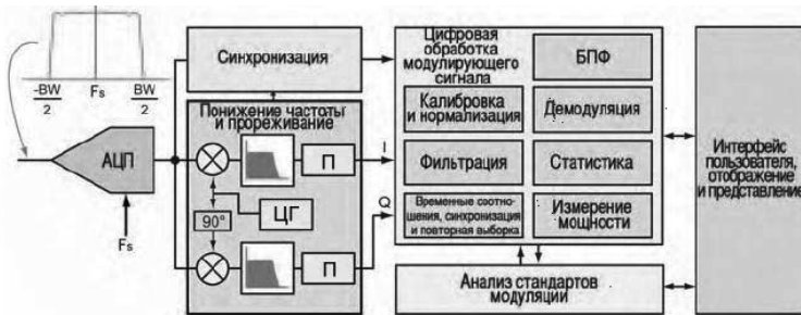
Рис. 2.5. Функциональная схема цифрового преобразования анализаторов реального спектра
