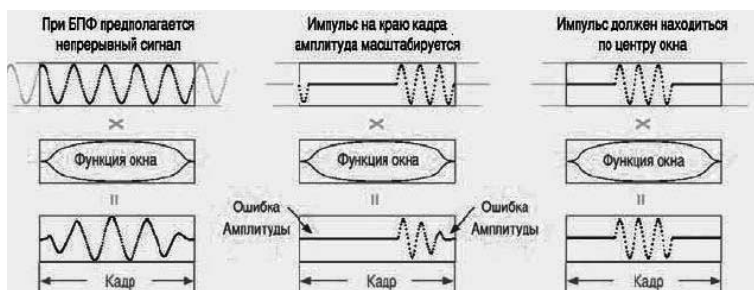
Рис. 2.46. Оконное преобразование для непрерывного сигнала (слева) и радиопульса: в центре при неудачном расположении импульса и справа при удачном расположении
